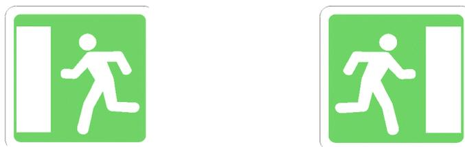
Необходимо также указывать два ближайших выхода на боковых стенах туннеля примерно через каждые 50 метров на высоте 1-1,5 метра. **В качестве фона должен использоваться зеленый цвет.** Примеры приводятся ниже:
