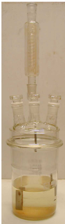
Figure 2: Réacteur avec réfrigérant à reflux
