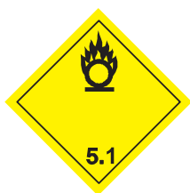
(Nº 5.1) División 5.1 Sustancias comburentes Símbolo (llama sobre un círculo): negro; Fondo: amarillo; Cifra “5.1” en el ángulo inferior
