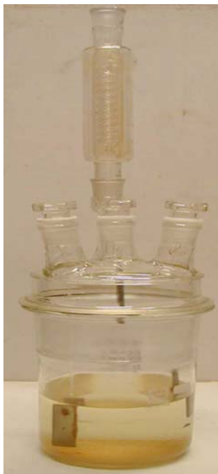
Figura 37.4.2: REACTOR PROVISTO DE REFRIGERANTE CON REFLUJO
