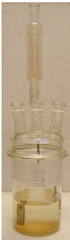
Рис. 37.4.2: Реакционный сосуд с парциальным конденсатором
