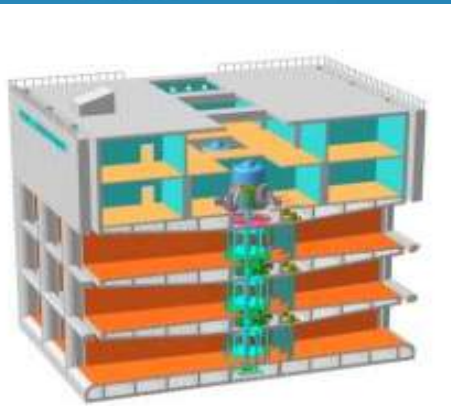
Агрегатный блок ПЭС в разрезе
