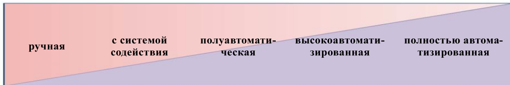
Рис. 1 Спектр функций в системе автоматизации транспортных средств (Flemisch et al., 2008)
