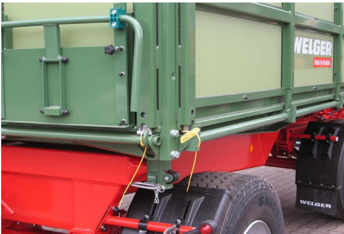
**Фото 27:** Использование печатей с индикацией признаков несанкционированного вскрытия запорных устройств задней и боковых дверей транспортного средства для перевозки грузов навалом.
