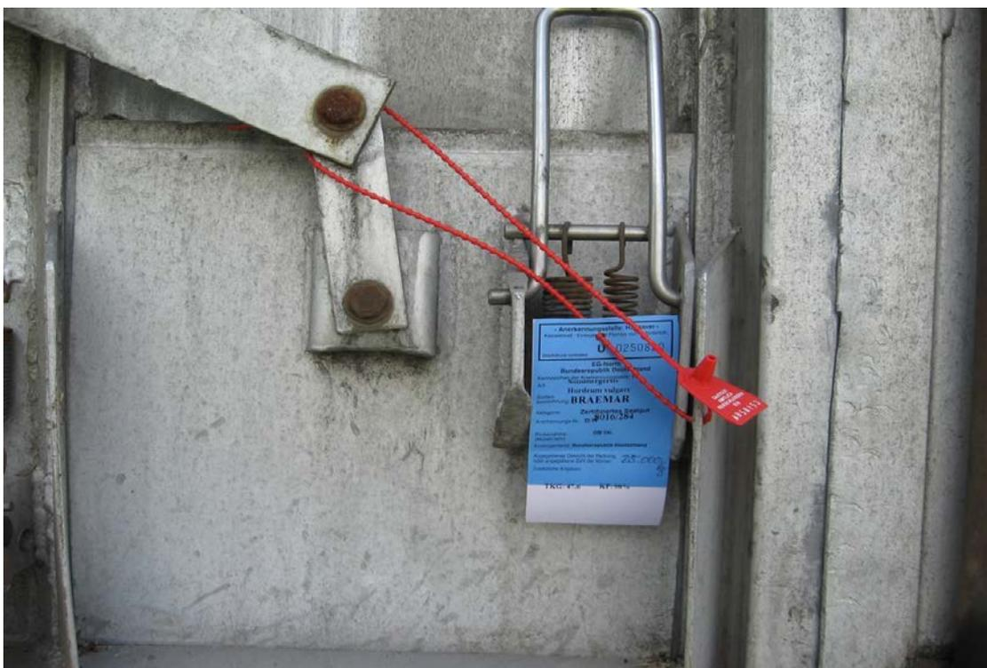
**Фото 25:** Использование номерной печати с индикацией признаков несанкционированного вскрытия тары на транспортном средстве для перевозки навалом.
