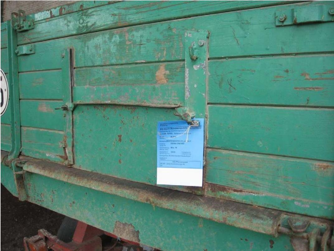
**Фото 28:** Использование печати с индикацией признаков несанкционированного вскрытия запорных устройств задних дверей транспортного средства, используемого для перевозки корзин навалом.
