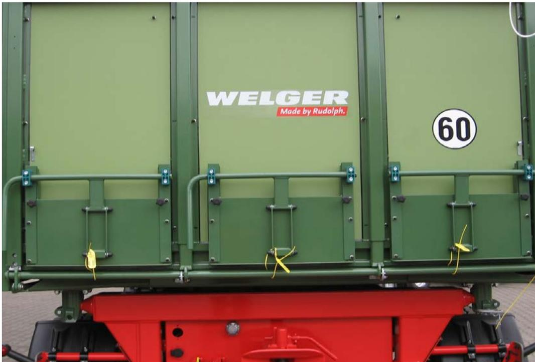
**Фото 26:** Использование печатей с индикацией признаков несанкционированного вскрытия дверей транспортного средства для перевозки грузов навалом.
