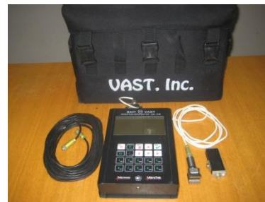
Ультразвуковой расходомер (для изм. расх. воды при натурных испытаниях ГЭС и НС)
