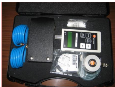
Твердомер портативный (для измерения твердости металлических конструкций и напорных трубопроводов неразрушающим методом)
