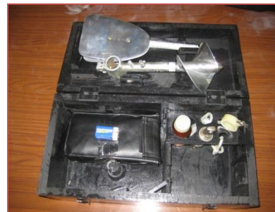
Вертушка (для измерения расхода воды)
