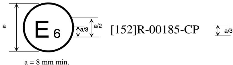
La marque d'homologation ci-dessus, apposée sur un véhicule, indique que le type de ce véhicule a été homologué en Belgique (E 6) en ce qui concerne le système actif de freinage d'urgence (AEBS), en vertu du Règlement n° [152] (avec les lettres C pour voiture contre voiture et P pour voiture contre piéton). Les deux premiers chiffres du numéro d'homologation indiquent que l'homologation a été délivrée conformément aux dispositions du Règlement n° [152] dans sa forme originale.
