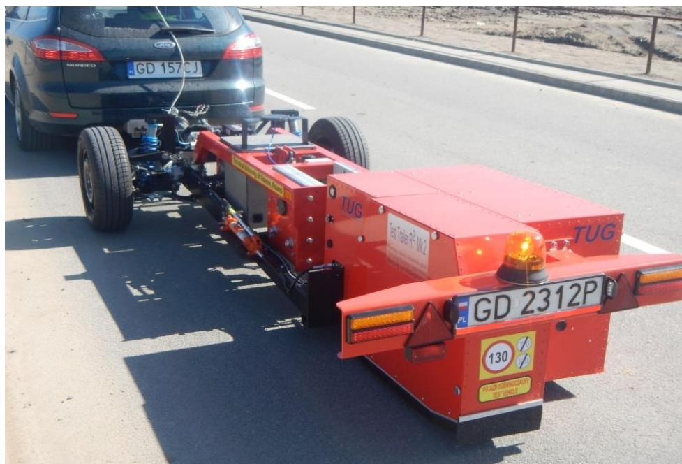
4.4.2.3 В 2012 году на базе прицепной тележки Гданьского ТУ было проведено изучение характера воздействия температурных различий на величину коэффициента сопротивления качению [M+P.DVS.12.08.3]. Измерения значений температуры боковины шины, дорожного покрытия и воздуха проводились одновременно с
