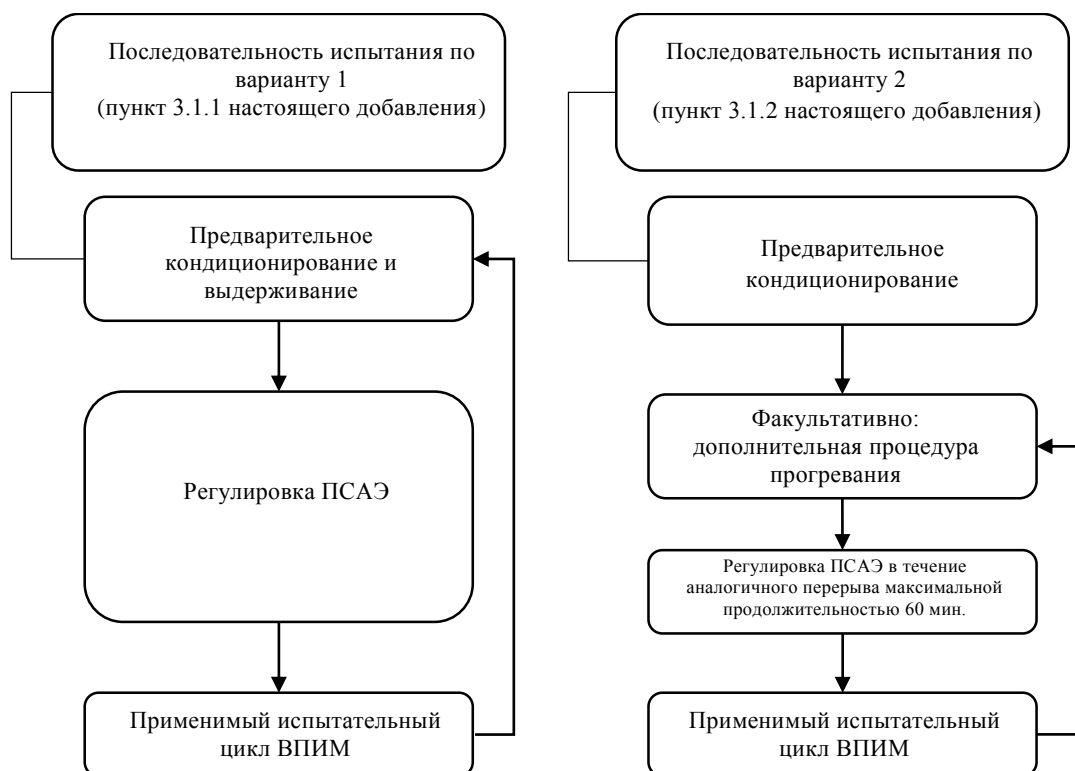
Рис. А8. App2/1 Последовательности испытания ГЭМ-ВЗУ
