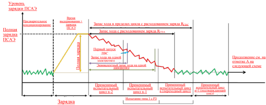
Рис. A8.App1/3 ГЭМ-ВЗУ, испытание типа 1 в режиме расходования заряда с последующим испытанием типа 1 в режиме сохранения заряда
