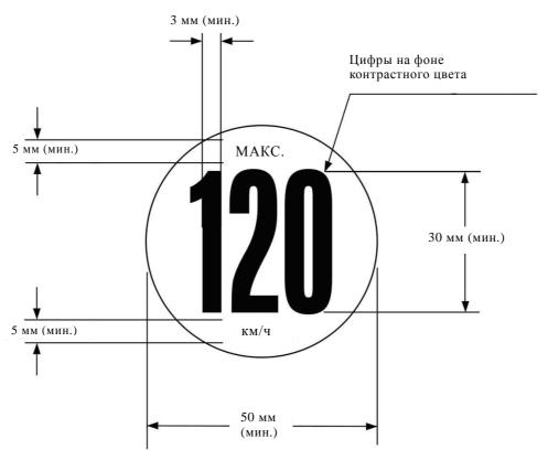
В случае транспортных средств, предназначенных для реализации в странах, где применяются единицы британской системы мер и весов, на наружной стороне колеса в заметном месте должен наноситься дополнительный постоянный предупреждающий знак, идентичный описанному выше знаку, за исключением того, что вместо значения "120 км/ч" используют значение "75 миль в час".
