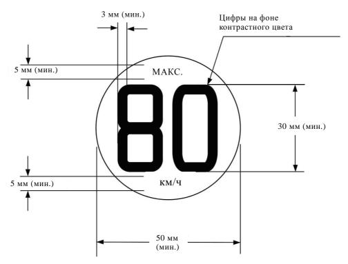
В случае транспортных средств, предназначенных для реализации в странах, где применяются единицы британской системы мер и весов, на наружной стороне колеса в заметном месте должен наноситься дополнительный постоянный предупреждающий знак, идентичный описанному выше знаку, за исключением того, что вместо значения "80 км/ч" используют значение "50 миль в час".
