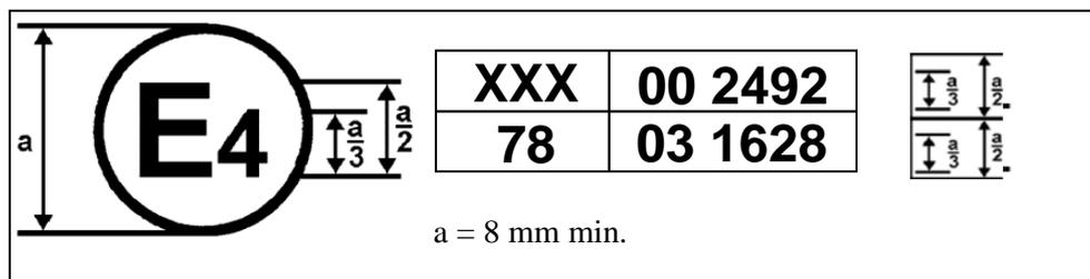
La marque d'homologation ci-dessus apposée sur un véhicule indique que le véhicule routier électrique à batterie concerné a été homologué aux Pays-Bas (E4) conformément aux Règlements n<sup>os</sup> [XXX] et 78\*. Les deux premiers chiffres des numéros d'homologation indiquent qu'à la date où les homologations respectives ont été accordées, le Règlement n<sup>o</sup> [XXX] était sous sa forme originale et le Règlement n<sup>o</sup> 78 était modifié par la série 03 d'amendements.
