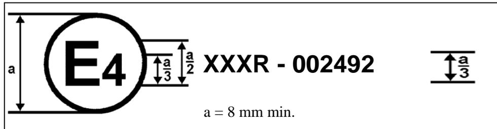
La marque d'homologation de la figure 1 apposée sur un véhicule indique que le type concerné de véhicule routier électrique à batterie a été homologué aux Pays-Bas (E4) conformément au Règlement n° [XXX] sous le numéro d'homologation 002492. Les deux premiers chiffres du numéro d'homologation indiquent que celle-ci a été accordée conformément aux prescriptions du Règlement n° [XXX] sous sa forme d'origine.
