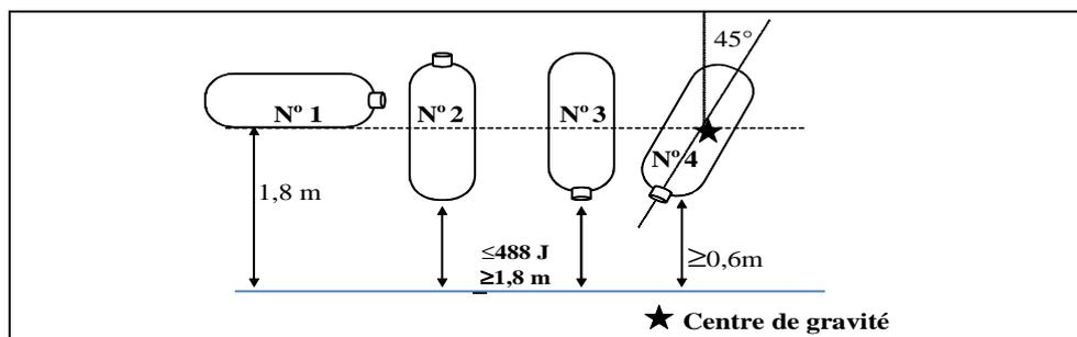
Aucune mesure ne doit être prise pour empêcher les réservoirs de rebondir lors du choc, mais on peut les empêcher de se renverser lors de l'essai de chute verticale décrit ci-dessus.
