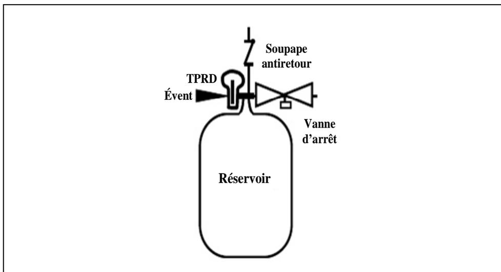
Tous les nouveaux systèmes de stockage de l'hydrogène comprimé fabriqués pour des véhicules d'usage routier doivent avoir une PSN inférieure ou égale à 70 MPa et une durée de vie en service maximale de 15 ans et être capables de satisfaire aux prescriptions du paragraphe 5.
