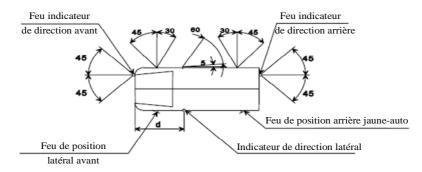
(\*\*) La valeur de  $5^{\circ}$  donnée pour l'angle mort de visibilité vers l'arrière du feu indicateur de direction latéral est une limite supérieure; d  $\leq 2,50$  m.
