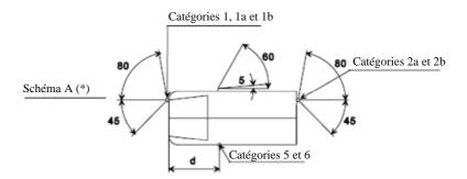
(\*) La valeur de 5° donnée pour l'angle mort de visibilité vers l'arrière du feu indicateur de direction latéral est une limite supérieure;  $d \le 1,80$  m (pour les véhicules des catégories  $M_1$  et  $N_1$ ,  $d \le 2,50$  m).
