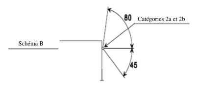
6.5.5.2 Ou, au choix du constructeur, pour les véhicules des catégories  $M_1$  et  $N_1$ : Feux indicateurs de direction avant et arrière, et feux de position latéraux (\*\*).
