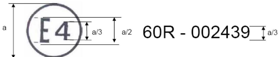
La marque d'homologation ci-dessus, apposée sur un véhicule, indique que le type de ce véhicule a été homologué aux Pays-Bas (E 4), en ce qui concerne les commandes actionnées par le conducteur, en application du Règlement n° 60 et sous le numéro d'homologation 002439. Le numéro d'homologation indique que l'homologation a été délivrée conformément aux prescriptions du Règlement n° 60 sous sa forme originale.
