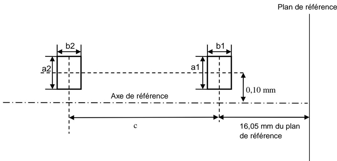
Orientations pour les mesures: source lumineuse vue de dessus et de côté.
