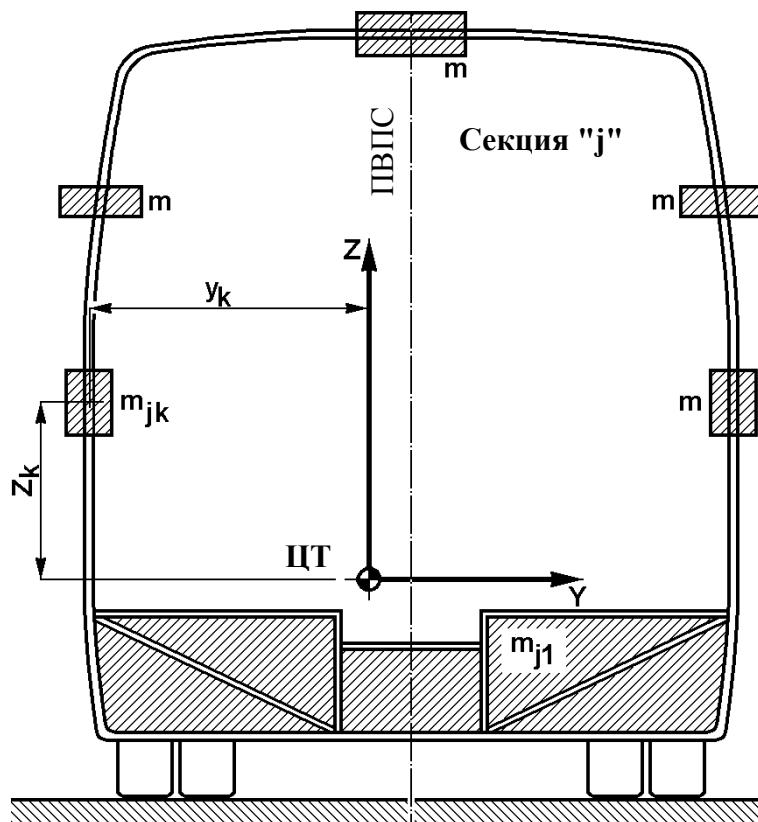
Рис A4.4 – Распределение массы в поперечном разрезе секции
