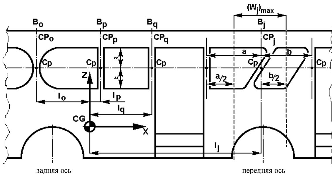
Рис. А4.2 - Определение длины секций силовой структуры
