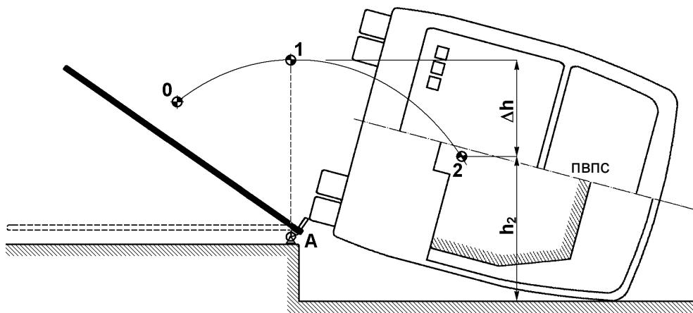
Рис. A7.A1.2 - Определение величины вертикального перемещения центра тяжести транспортного средства
