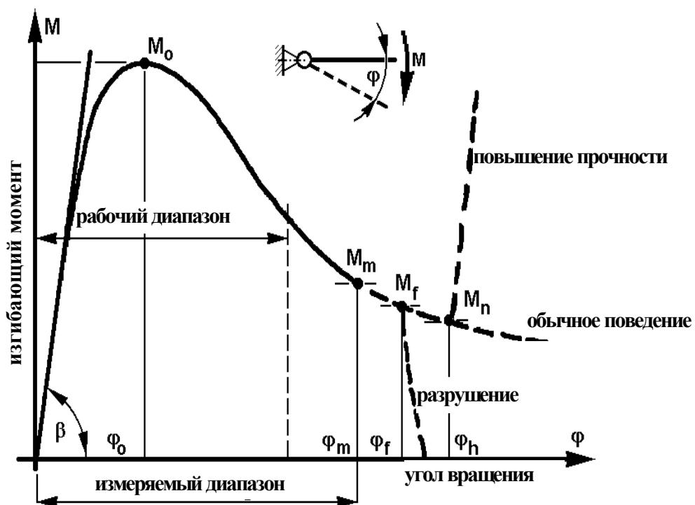
Рис. А8.А1.1 - Кривая характеристик пластического шарнира
