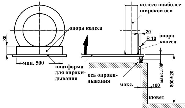
Рис. А5.1 – Геометрические характеристики устройства для опрокидывания
