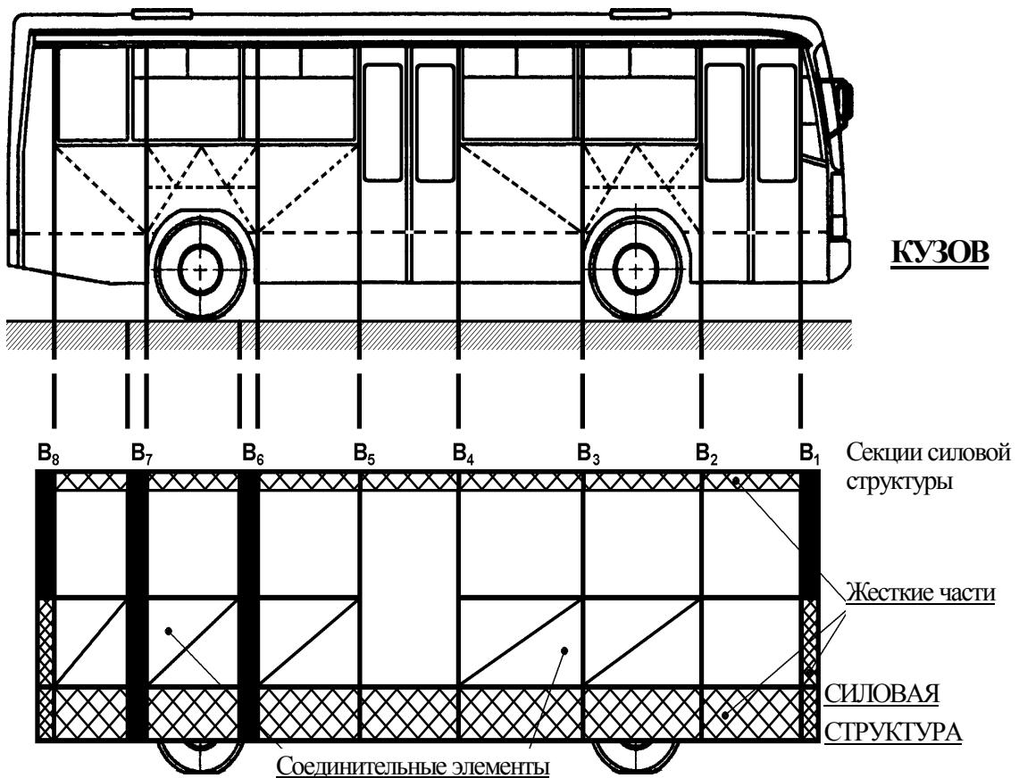
Рис. А4.1 - Определение силовой структуры по кузову
