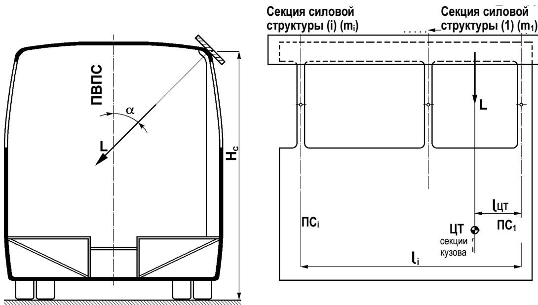
Рис. A7.1 - Применение нагрузки к секции кузова
