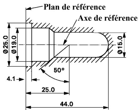
Figure 2. Encombrement maximal³
