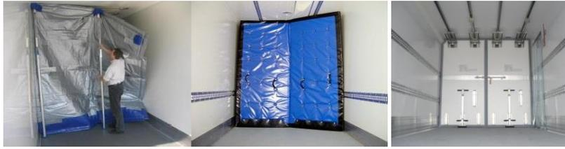
3. La certification d'un engin multi-températures nécessite d'évaluer la capacité des cloisons internes à maintenir une séparation physique et thermique de deux compartiments adjacents dans l'engin pendant le transport des denrées périssables.
