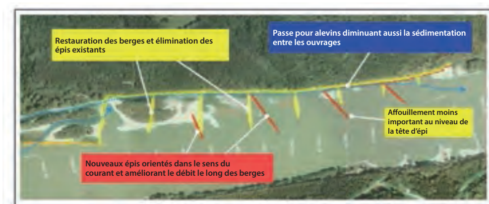
Figure 59. Mesures d'ingénierie fluviale utilisées dans le projet pilote de Witzelsdorf (Siedl, 2012). Les anciens épis (en jaune) sont remplacés par des épis mieux conçus afin de modifier l'écoulement de l'eau et la dynamique de formation de sédiments.
