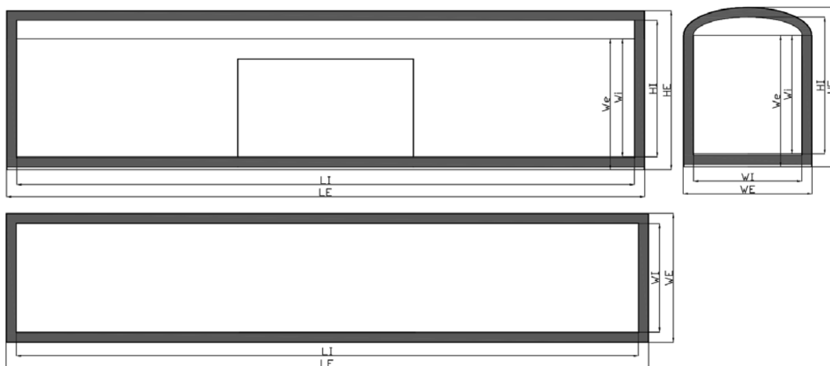
Рис. 6 – Расчетные обозначения кузова со скругленной крышей
