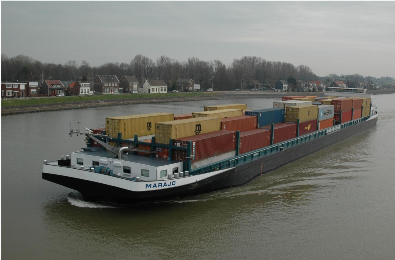
*Beispiel eines beladenen Containerschiffs, Maße 135 m x 17,42 m. Schiffe mit diesen Maßen sind mit 6 Reihen breit beladen. Dadurch ist es praktisch unmöglich, einen Saugschlauch vom Gangbord aus auf den Boden des Laderaums zu führen.*
