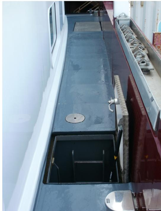
*Beispiel eines fest installierten Lüftungsschachtes vom Achterherft (Deck) aus, mündet im Laderaum.
