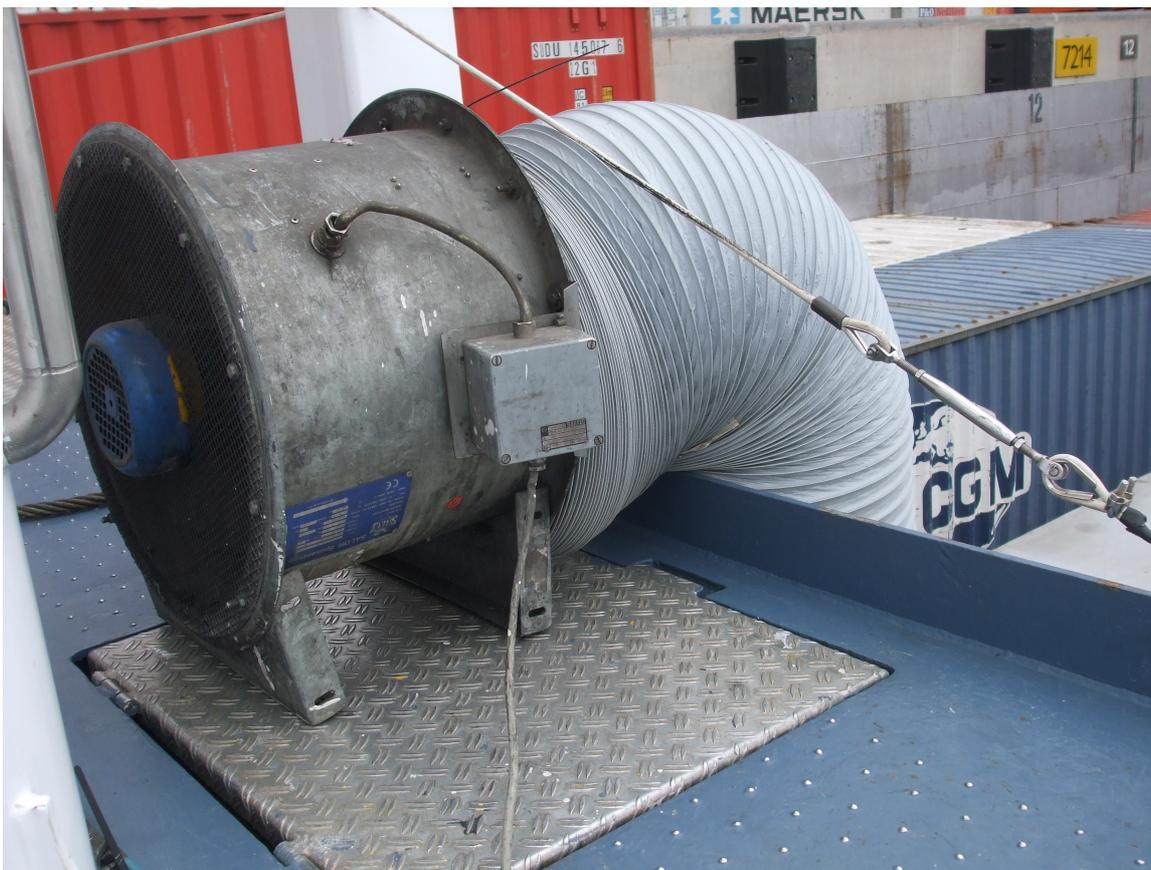
*Installierter mobiler Ventilator und Saugschlauch an Deck über dem „Achterherft“.*
