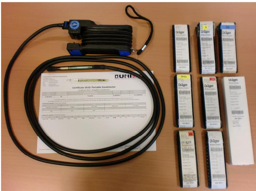
*Foto eines Toximeters (Gasspürpumpe) mit einigen Packungen unterschiedlicher Prüfröhrchen und Zertifikat.*
