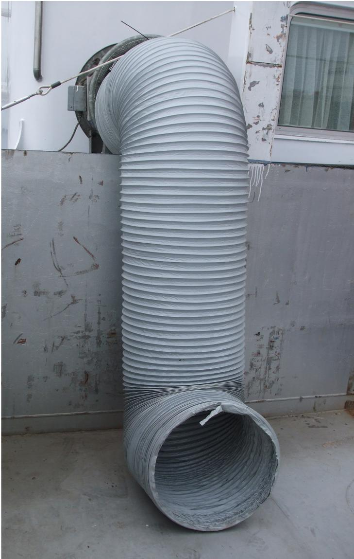
*Gleiche Situation, anderes Ende des Saugschlauches. Er liegt auf dem Dummy im Laderaum. Dieser Schlauch ist sowieso zu kurz, um unten in den Laderaum zu kommen. Der Auslass des Ventilators bläst Richtung Wohnung.*
