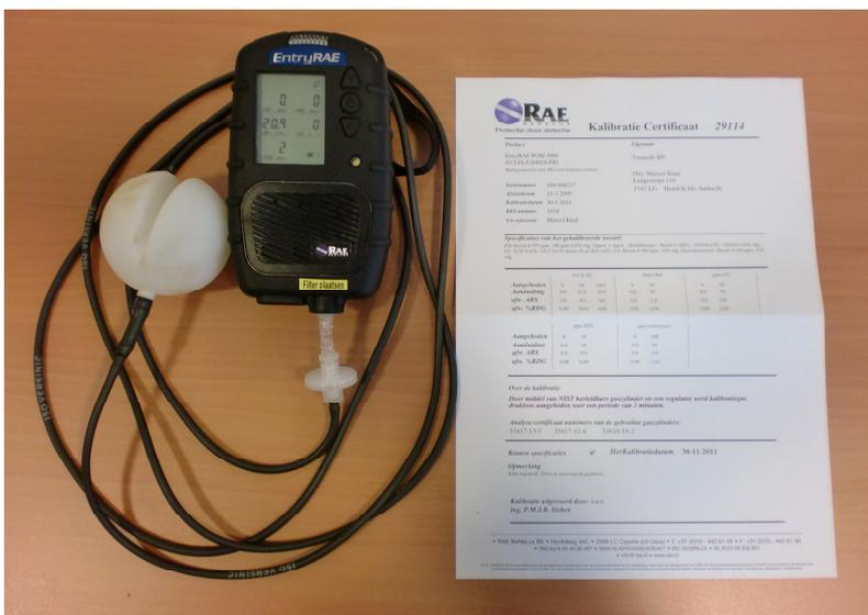
Foto eines beispielhaften PID-Messgeräts, das auch Sauerstoff, Explosionsgefährdung, H<sub>2</sub>S und CO misst, sowie das Zertifikat.
