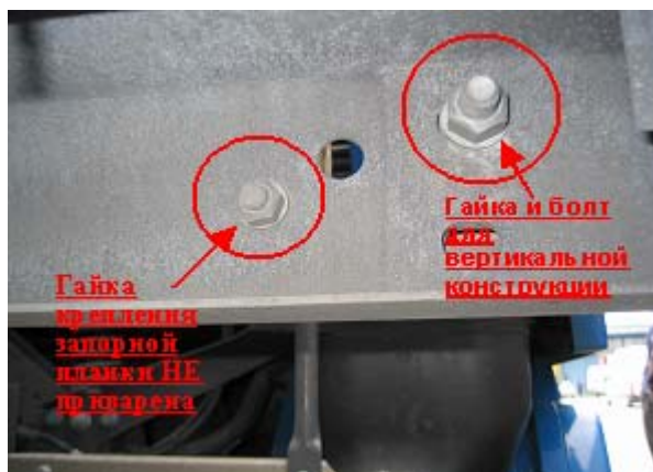
Внутренняя часть рамы шасси – гайка запорной планки НЕ заблокирована.
