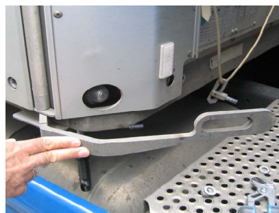
Внутренняя часть рамы шасси – гайка запорной планки НЕ заблокирована.
