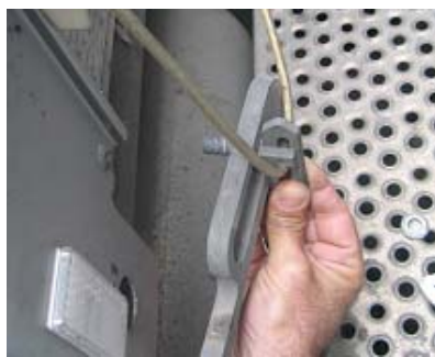
Внутренняя часть рамы шасси – гайка запорной планки НЕ заблокирована.
