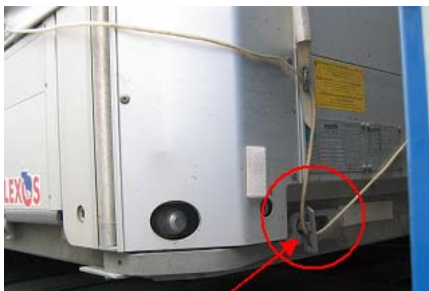
Запорная планка заблокирована тросом МДП.
