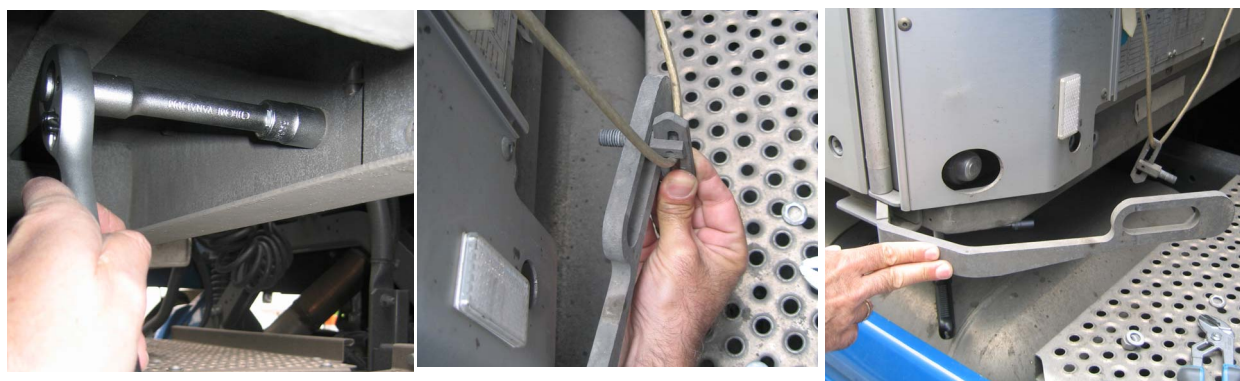
Côté interne du châssis – la languette de verrouillage n'est PAS sécurisée.
