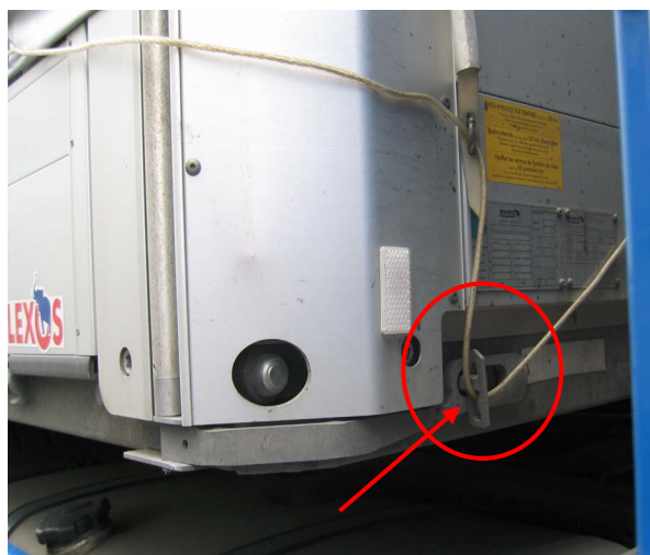
Languette de verrouillage sécurisée par le câble TIR.
