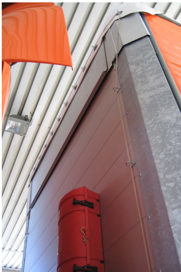
A: Anneaux métalliques TIR fixés sur la partie solide de la remorque et œillets renforcés introduits dans le bord de la bâche. La partie supérieure de la bâche est alors sécurisée et maintenue en place par le câble TIR. Ce système exige un câble TIR relativement long – environ 7 mètres de plus qu'un câble TIR standard.
