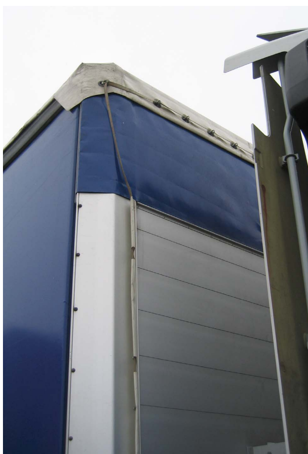
B: Anneaux métalliques TIR fixés sur la partie solide de la remorque et œillets renforcés introduits dans le bord de la bâche. La partie supérieure de la bâche est alors sécurisée et maintenue en place par une lanière conforme aux prescriptions stipulées par la Convention TIR en ce qui concerne sa matière et ses dimensions. Le câble TIR sécurise la partie inférieure de la lanière. Ce système nécessite un câble TIR de longueur normale.
